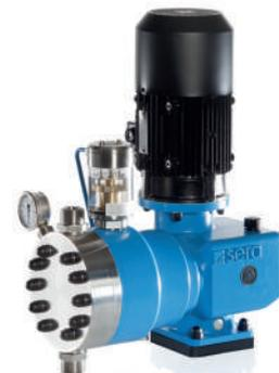
**R410.2 KM** расход жидкости: 30 - 850 литров в час противодавление, от...до 80 бар
